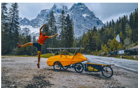
Après avoir construit un vélo électrique couché et caréné, Jacob Karhu est parti **faire un tour d'Europe de 12 000 km**. Avec la recharge solaire sur le toit et une batterie DIY, il roulait entre 100 et 300 km/jours, à 28 km/h de moyenne. Le carénage aérodynamique permet de consommer moins d'énergie pour se déplacer et il protège du soleil, de la pluie, du froid.
